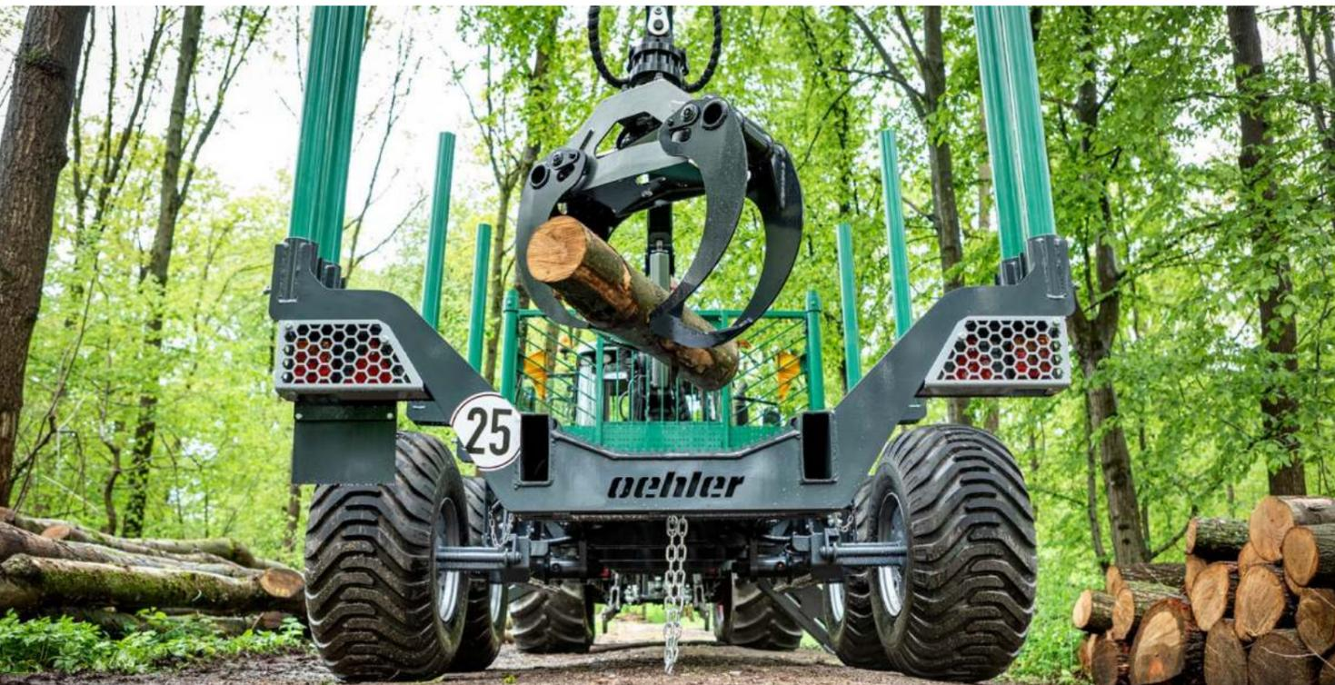
Einrohrrahmen mit verstellbaren Rungen
