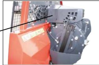
**Führung für ein genaues Aufwickeln des Drahtseils auf die Trommel**
