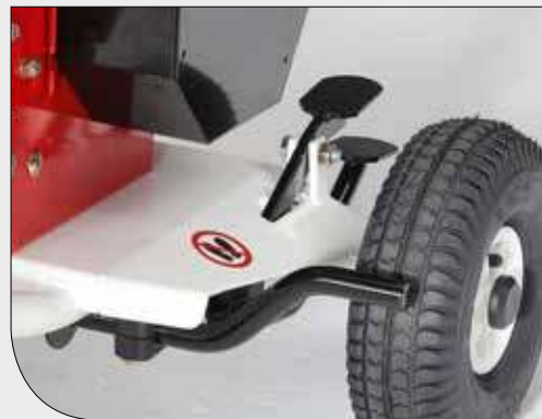
Die Feststellbremse sorgt für einen sicheren Stand während der Arbeit.
