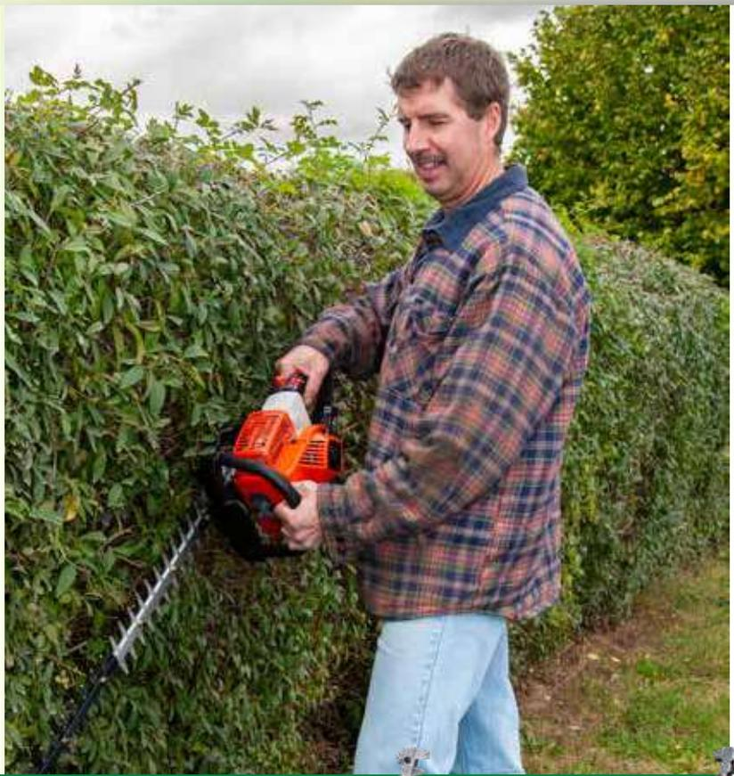
Die Hitachi/HiKOKI Heckenscheren können Sie selbst bei höchsten Anforderungen den besten Arbeitskomfort genießen. Der um 180° drehbare Handgriff ermöglicht Ihnen sowohl beim senkrechten als auch beim waagrechten Heckenschnitt eine nahezu ermüdungsfreie Arbeitshaltung.
