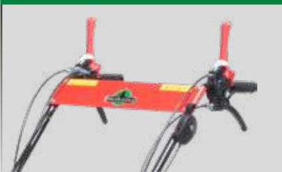
Optimale Griffposition in jeder Arbeitssituation durch den verstellbaren Holm.
