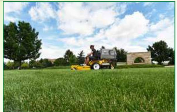
Großer Vorteil des flachen Frontmähwerks ist die Möglichkeit, auch unter Hindernissen zu mähen. Spätere Ausputzarbeiten entfallen mit einem Walker komplett.
