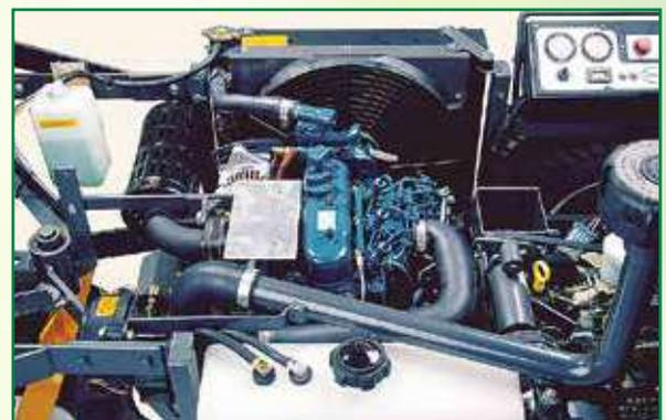
Durch Hochklappen der Grasfangbox leicht zu erreichen: der durchzugsstarke 3-Zylinder Dieselmotor.
