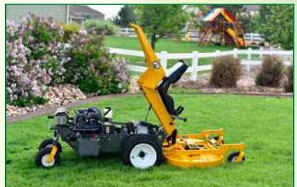
Komfortabler Wartungszugang - für den Zugang zur Technik können Sie einfach die komplette Abdeckung mit Sitz nach oben klappen.
