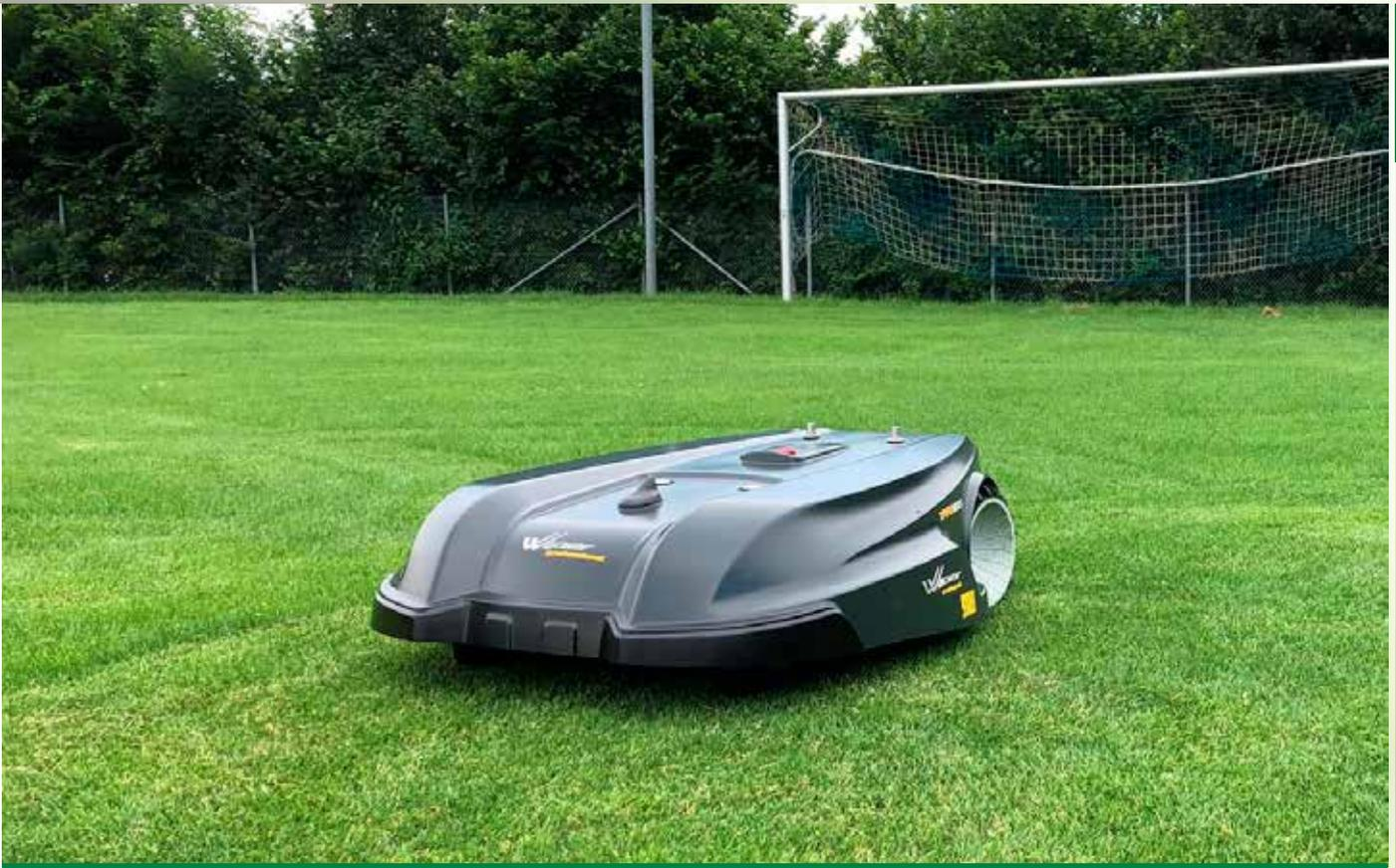
**Der extrem leistungsstarke Wiper Yard 2000S hat eine beeindruckende Schnittbreite von 84 cm.** Er erreicht damit eine Flächenleistung von bis zu 20.000 m<sup>2</sup> und die max. Mähleistung beträgt bemerkenswerte 900 m<sup>2</sup>/h. Der Wiper Yard 2000S mäht bis zu 11 Stunden mit einer Akkuladung und eignet sich daher optimal für z.B. Sport- und Golfplätze, Hotels oder Parkanlagen.
