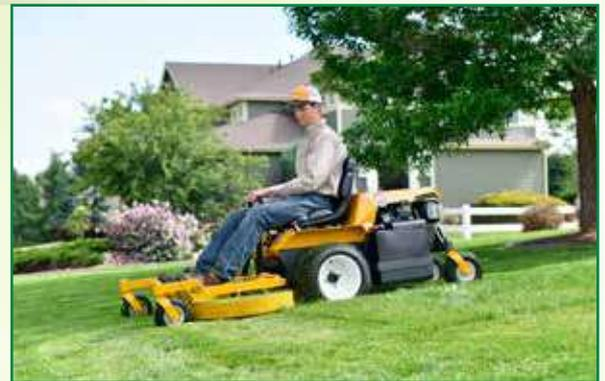
Bequeme Sitzposition und geniale Steuerung des Mähers durch die Kombination von getrenntem Lenk- und Geschwindigkeitshebel.
