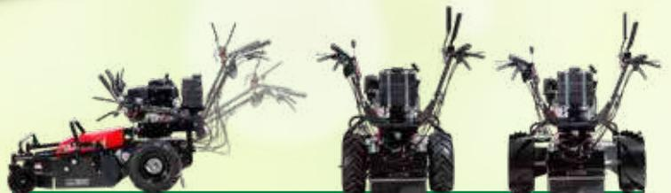
Der Holm ist voll verstellbar und für den Transport der Maschine auch komplett umklappbar.
