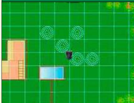
Der Roboter mäher erzeugt durch die satellitengestützte Navigation eine virtuelle Grundstückskarte und erkennt so die bereits gemähten Rasenflächen.
