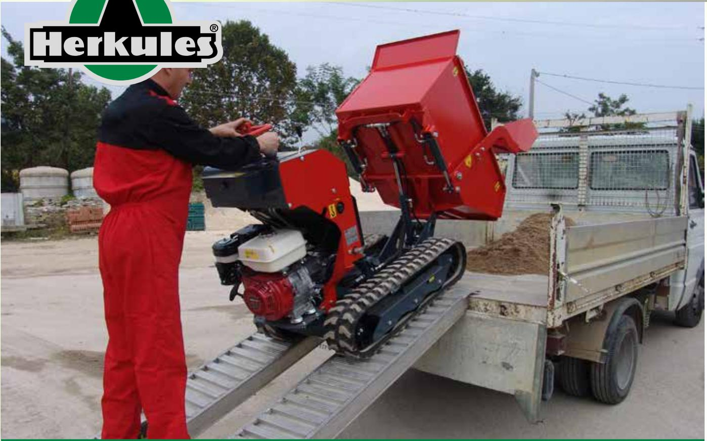
**Der Herkules 8.0 HE Hydro<sup>3</sup> ist als Spitzenmodell** wahlweise mit einem leistungsstarken Honda-Benzinmotor mit 8,7 kW oder mit einem Yanmar-Dieselmotor mit 6,6 kW und Elektrostart ausgestattet. Zusätzlich bietet der Rau-
