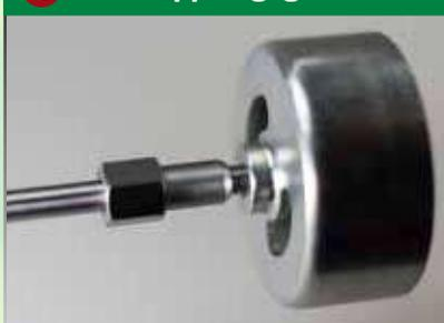
Die Antriebswelle wird direkt mit der Kupplungsglocke verschraubt, wodurch die Haltbarkeit extrem erhöht und die Vibrationen vermindert werden.
