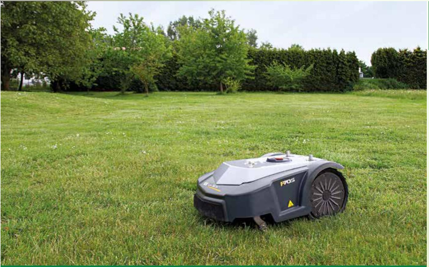
**Der Wiper P70S ist prädestiniert für große Mähflächen bis 7.000 m<sup>2</sup>.** Mit einer Akkuladung kann der Roboter mäher bis zu 7 Stunden vollautomatisch mähen.
