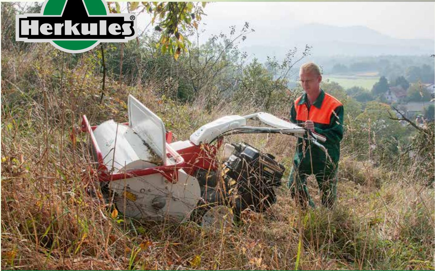
Mit dem stufenlosen hydrostatischen **Fahrtrieb** lässt sich der HRH 801 Hydro komfortabel steuern. In Kombination mit der Schnittbreite von 80 cm lassen sich große Flächen schnell bearbeiten.
