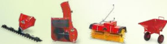
Herkules Frontgeräteträger sind universell einsetzbare Grundmaschinen mit einer Vielzahl von Anbaubehör für unterschiedlichste Einsatzzwecke. Das Herkules Schnellkuppelsystem ermöglicht dabei den werkzeuglosen Gerätewechsel in kürzester Zeit. Das Anbaubehör wird über die integrierte Frontzapfwelle angetrieben.
