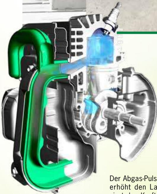
Der Abgas-Pulsationsschalldämpfer erhöht den Ladedruck und reduziert den Kraftstoffverbrauch. Das Gas-Luftgemisch wird über eine Rückführung des Schalldämpfers zurück in den Zylinder geleitet. Durch dieses Verfahren werden die Emissionswerte deutlich reduziert.
