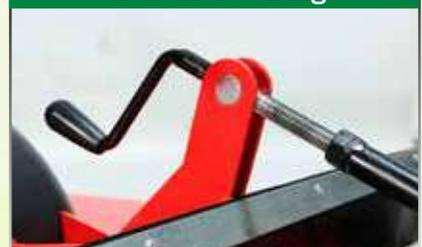
Die stufenlose Schnitthöhenverstellung erfolgt über eine Spindel am Mähdeck
