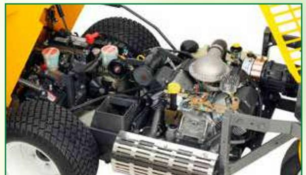
Die leistungsstarke Antriebseinheit - der Kohler OHC 2-Zylinder sorgt für ausreichend Kraftreserven.
