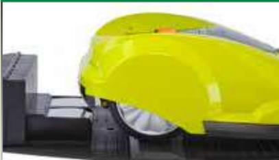
Der Mähroboter fährt automatisch zur Ladestation, sobald der Akku aufgeladen werden muss.
