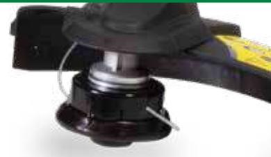
Alle Motorsensen werden mit halbautomatischem Fadenkopf geliefert
