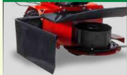
Zum sauberen Ablegen des Schnittgutes in einer Reihe dient der Schwadformer.
