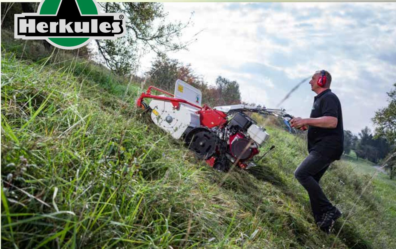
Für noch bessere Traktion in unwegsamem Gelände bietet Herkules jetzt auch einen Schlegelmäher mit Raupenantrieb. Im Wesentlichen auf Basis des Schlegelmähers HR 662 H konstruiert, sorgt der Raupenantrieb auch in Hanglagen für ein spurtreues Mähen. Extremes Gefälle oder starke Steigungen werden problemlos von der Maschine gemeistert. Dank Einzelradkupplung bleibt der Mäher auch in schwierigem Gelände leicht zu manövrieren.
