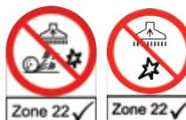
Diese Sauger sind für die Aufnahme explosiver Stäube sowie für Stäube der Staubklassen L und M zugelassen. Dazu gehören Hartholzstäube, alle nicht krebserregenden Stäube mit AGW-Werten > 1,0 mg/m<sup>3</sup> und/oder entzündliche Stäube für Anwendungen in ATEX Zone 22.
