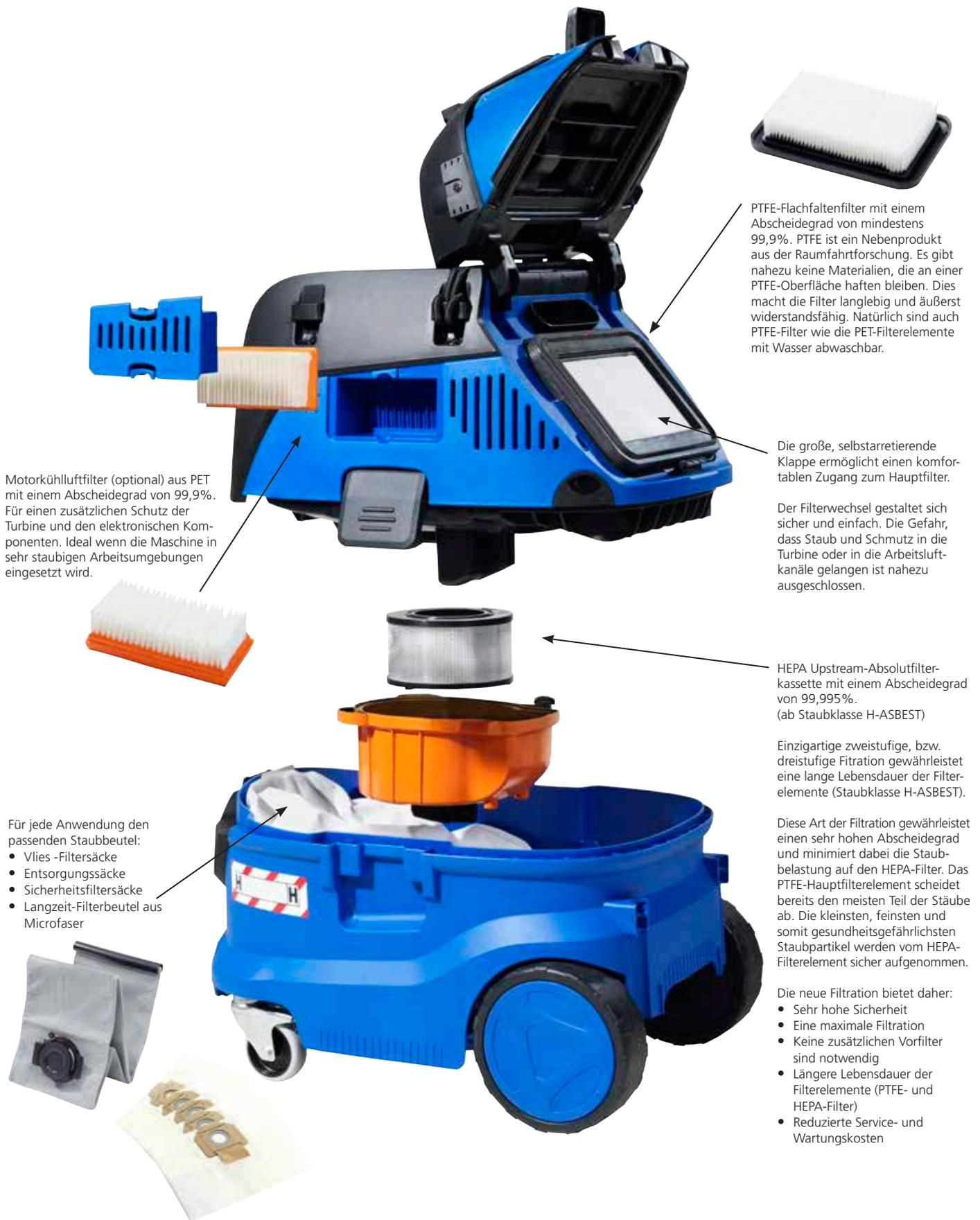
Motorkühlfilter (optional) aus PET mit einem Abscheidegrad von 99,9%. Für einen zusätzlichen Schutz der Turbine und den elektronischen Komponenten. Ideal wenn die Maschine in sehr staubigen Arbeitsumgebungen eingesetzt wird.
