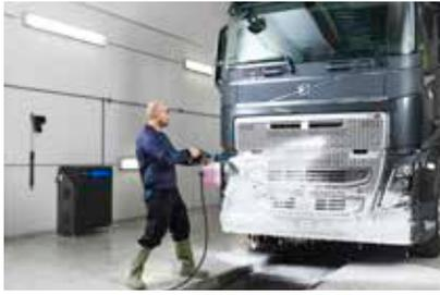
**Stationäre 2-Pumpen-Hochdruckreiniger für anspruchsvolle Reinigungsaufgaben**
