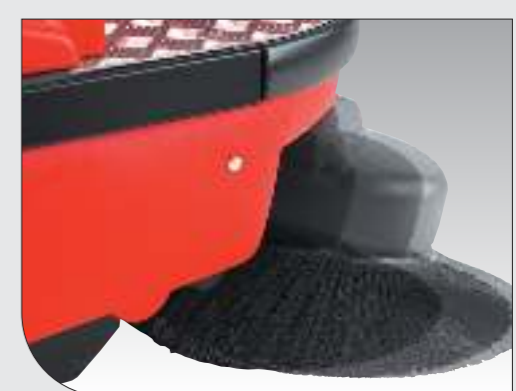
Die Seitenbesen weichen Hindernissen selbständig aus.
