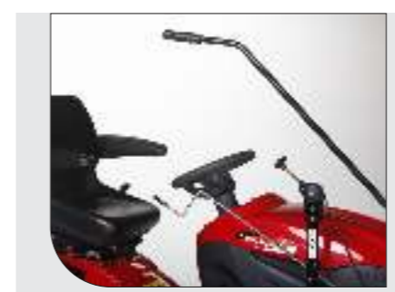
Vom Fahrersitz aus sind Wurfwinkel und Wurfhöhe zu steuern
