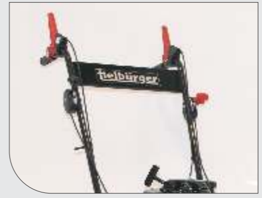
3-Gang-Getriebe vom Lenker schaltbar
