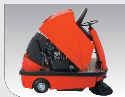
Einfacher Zugang zur Technik , werkzeugloser Walzenwechsel in weniger als 3 Minuten.
