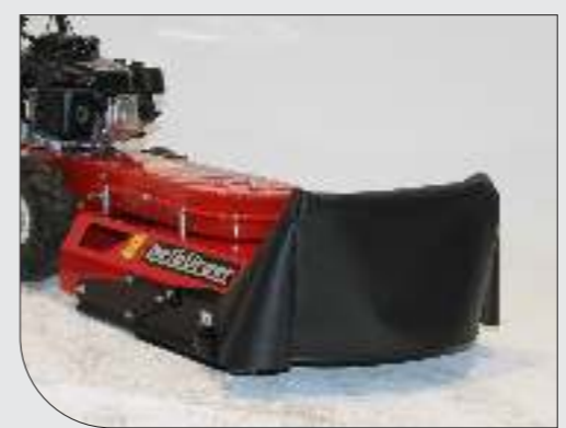
Die DLG-zertifizierte Schutzplane verringert den Gefahrenkreis vor der Maschine. AY-032-001TS
