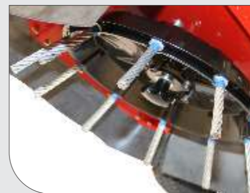
Werkzeugteller mit Schnellwechselsystem zum Borstenwechsel.
