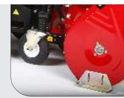
Stützräder und Gleitkufen zur Entlastung der Vorderachse
