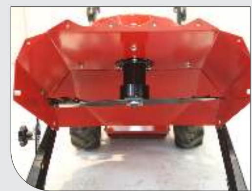
Das auf den Abtransport des Mähguts optimierte Mähdeck mit Wicklechutz für das Mulchmesser .
