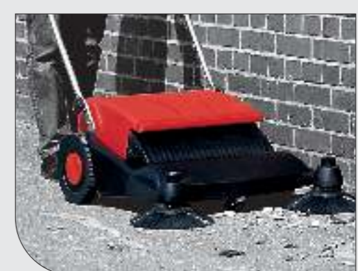
Wandschlüssiges Kehren durch Seitenbesen, die Kehrgut aus Ecken / Kanten fegen.
