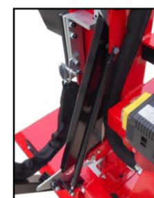
Stammheber mit hydraulischer Dämpfung
